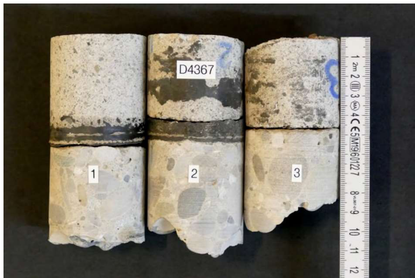
Bild 8 Bohrkerne 1 bis 3 mit \varnothing 50 mm, welche aus dem Belagsfenster BI1 entnommen wurden. Die Dicke des Schutzmörtels beträgt zwischen 40 und 45 mm. Die zweischichtige PBD-Abdichtung weist eine Dicke von ca. 10 mm auf.
