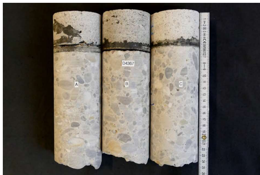
Bild 6 Bohrkern A bis C mit Ø 80 mm, welche aus dem Belagsfenster Bl1 entnommen wurden. Die Dicke des Schutzmörtels beträgt zwischen 45 und 50 mm. Die zweischichtige PBD-Abdichtung weist eine Dicke von ca. 10 mm auf.
