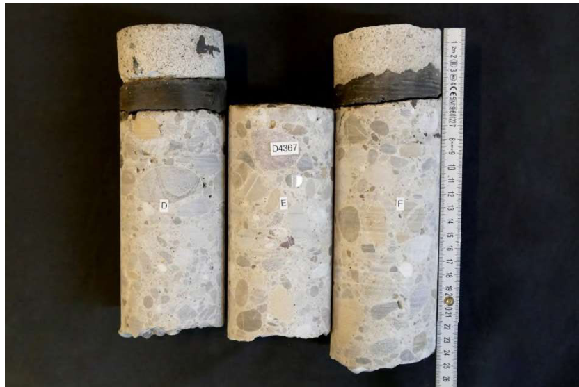
Bild 7 Bohrkerne D bis F mit \varnothing 80 mm, welche aus dem Belagsfenster BI2 entnommen wurden. Die Dicke des Schutzmörtels beträgt ca. 35 mm. Die dreischichtige PBD-Abdichtung weist eine Dicke von ca. 15 mm auf.
