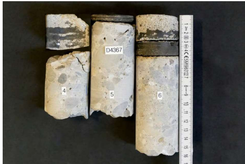
Bild 9 Bohrkerne 4 bis 6 mit Ø 50 mm, welche aus dem Belagsfenster BI2 entnommen wurden. Die Dicke des Schutzmörtels beträgt zwischen 30 und 40 mm. Die zweischichtige PBD-Abdichtung weist eine Dicke von 10 bis 15 mm auf.
